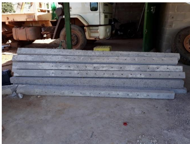
Figura 33 – Estacas de concreto
