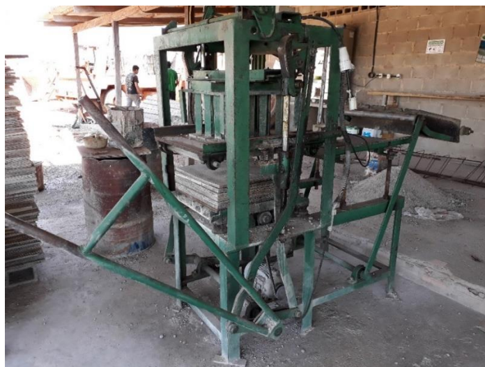
Figura 30 – Equipamento para fabricação dos blocos de concreto
