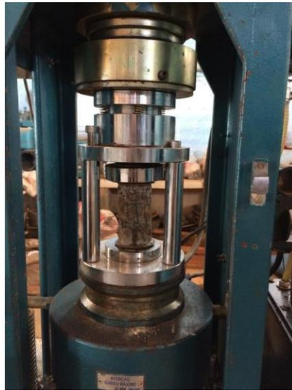
**Figura 3** - Prensa Eletrohidráulica utilizada para romper os corpos de prova
