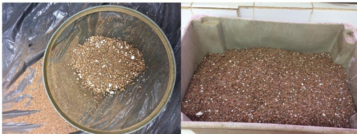
**Figura 2** – Processo de beneficiamento, à esquerda, peneiramento do material e, à direita, material peneirado pronto a ser utilizado no concreto granilite.
