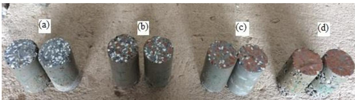
Figura 9 – Aspectos visuais dos diferentes concretos granilites desenvolvidos neste estudo, (a) Traço M, (b) Traço I, (c) Traço II, e (d) Traço III.
