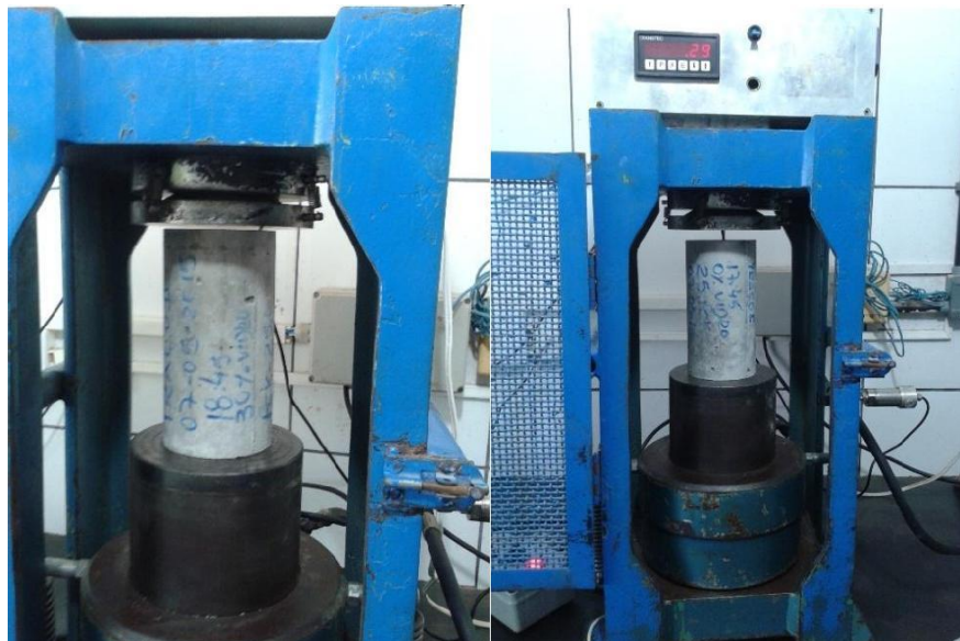
Figura 3.4.2 – Rompimentos dos Corpos de provas
