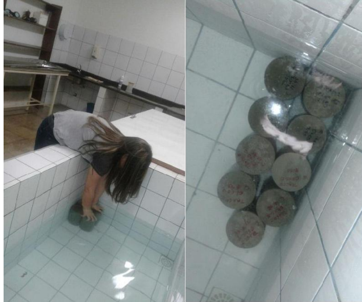
Figura 3.3.4 – Cura dos corpos de provas por imersão em água
