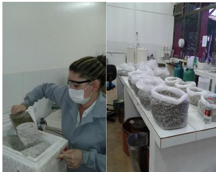
Figura 3.2.3 – Pesagem dos materiais
