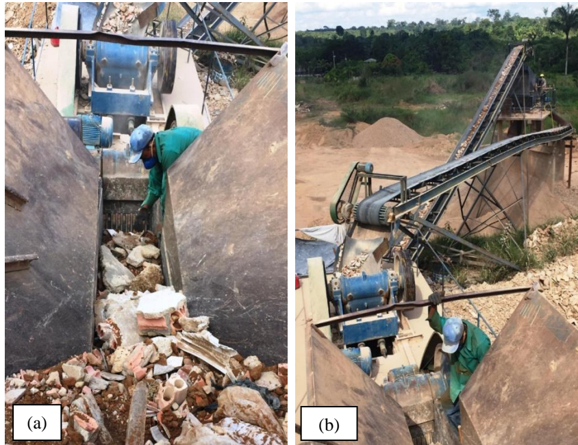
Figura 9: (a) Funil de entrada do alimentador vibratório (vibrador primário) e (b) Sistema de correias para separação do material.
