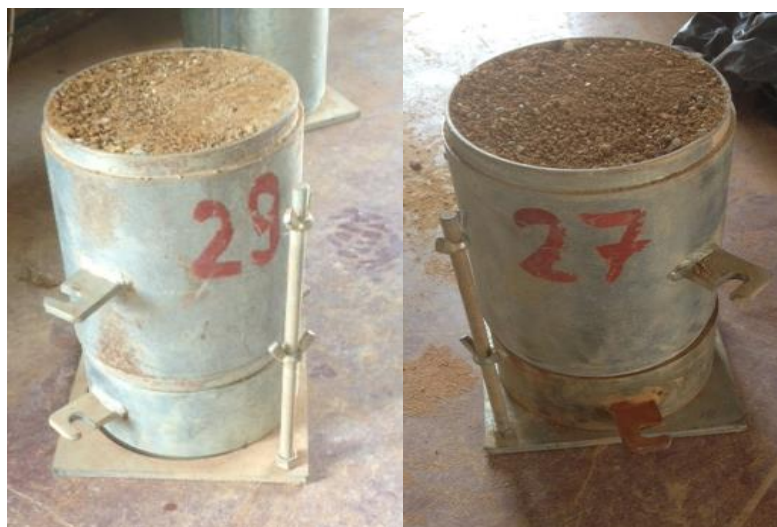
Figura 8 - Duas amostras para a determinação do CBR, ensaio para Sub-base.
