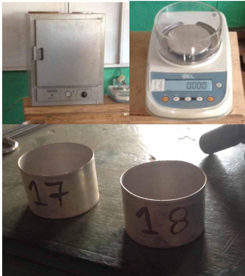
Figura 7 – Equipamentos para o ensaio de teor de umidade no DER – RO.
