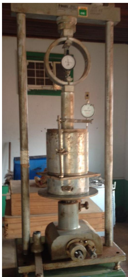
Figura 9 – Amostra passando pela penetração (prensa manual no DER – RO).
