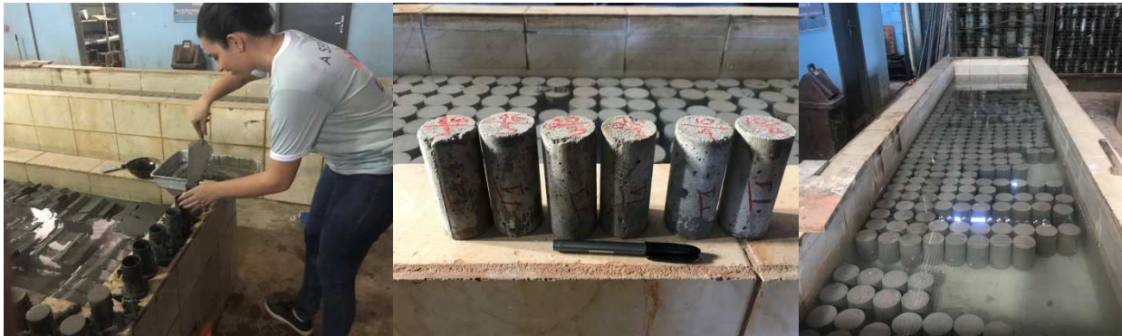
Figura 4 - Montagem do corpo de prova, corpo de prova pronto após 24 horas e cura dos corpos de provas por imersão em água.
