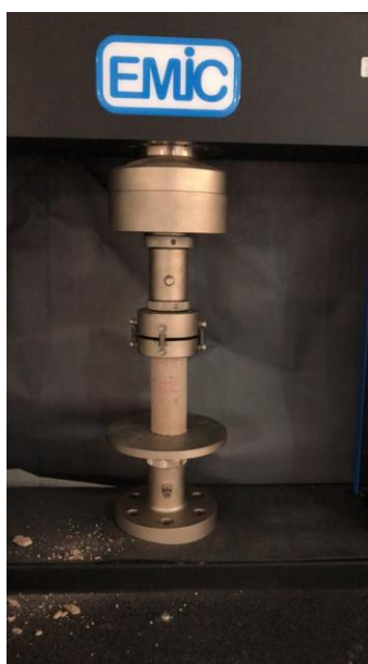
Figura 7 – Ensaio de resistência à compressão dos corpos de prova
