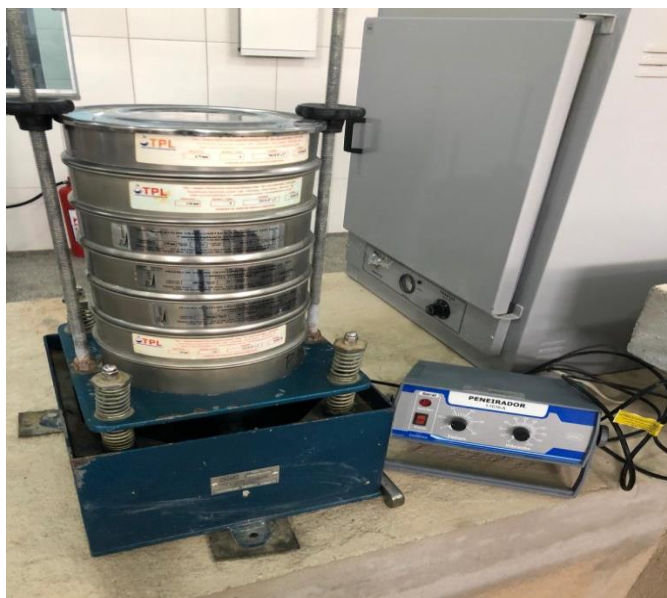
Figura 5 – Ensaio de determinação da composição granulométrica
