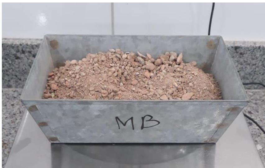
Figura 4 – Amostra de Resíduo miúdo misto de Construção Civil
