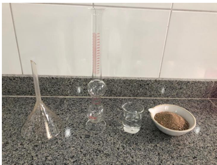
Figura 6 – Ensaio de determinação de massa específica de agregados miúdos por meio do frasco Chapman
